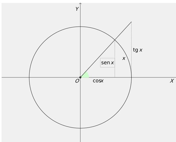
En la figura se ha representado un ángulo  $x$  sobre una circunferencia de radio 1. Si el radio es igual a la unidad, la longitud del arco coincide con la medida del ángulo en radianes. El seno y el coseno del ángulo son iguales a la ordenada y la abscisa del extremo del arco y así se han representado en la figura. También se ha representado un segmento de longitud igual a  $\text{tg } x$ .
