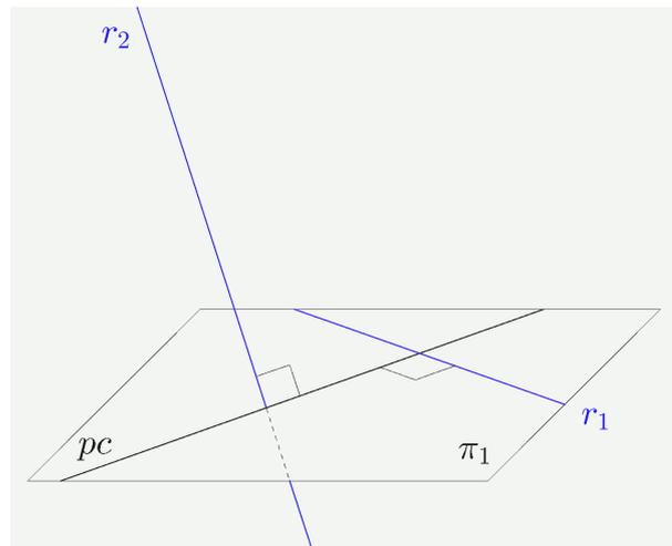
Figura 7.18: Perpendicular común a dos rectas que se cruzan
