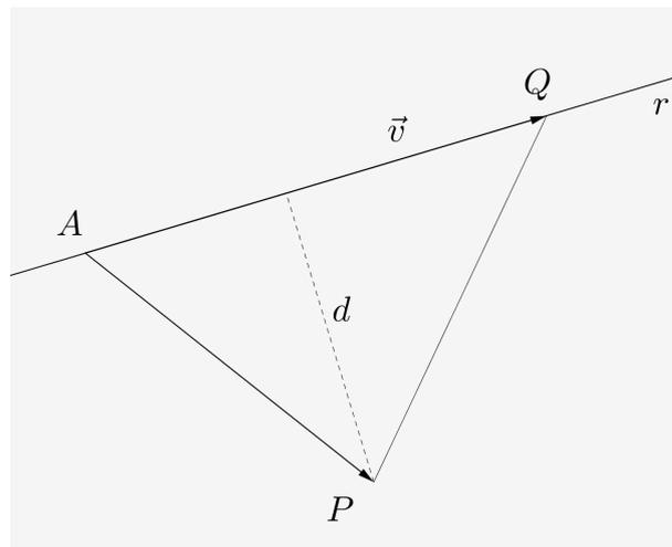
Figura 7.14: Distancia de un punto a una recta
