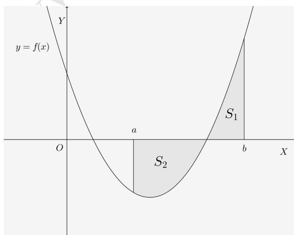
Figura 4.4: Integral definida y área:  $\int_a^b f(x) dx = S_1 - S_2$
